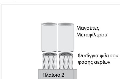
**2.** Το πλαίσιο 2 περιέχει τα τέσσερα φυσιγγιά φίλτρου της φάσης αερίων με τις τέσσερις μανσέτες μεταφίλτρου. Αφαιρέστε το πλαίσιο 2 με τα φυσίγγια.
