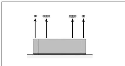
**4.** Αφαιρέστε τους σφιγκτήρες φίλτρου που ασφαλίζουν το φίλτρο στο πλαίσιο, τραβώντας αυτούς έξω από τους αύλακες ολίσθησης.
