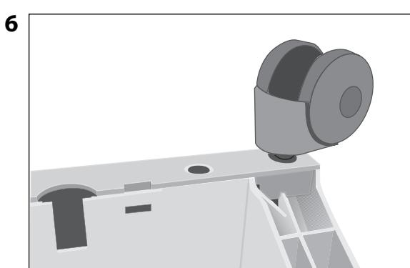
Βεβαιωθείτε ότι ο κάθε τροχίσκος έχει εφαρμόσει με ασφάλεια πριν τοποθετήσετε τον αεροκαθαριστή στην όρθια θέση, επάνω στους τροχίσκους.
