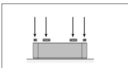
**10.** Βεβαιωθείτε ότι το φίλτρο έχει εισαχθεί εξ ολοκλήρου μέσα στο πλαίσιο. Τοποθετήστε τους σφιγκτήρες μέσα στους αύλακες ολίσθησης εντός του πλαισίου και πίεστε τους προς τα κάτω.
