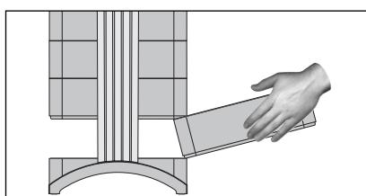
**11.** Τοποθετήστε το πλαίσιο πίσω στο περιβλήμα. Για λεπτομέρειες όσον αφορά πώς να κλείσετε το περιβλήμα, βλ. παράγραφο 6.3.
