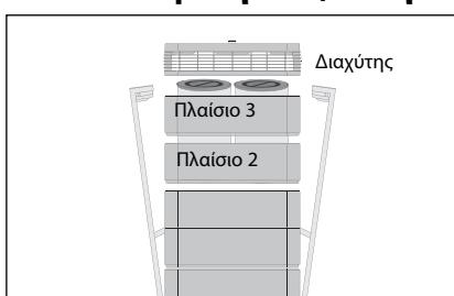
**1.** Ανοίξτε τους βραχίονες κλειδώματος, αφαιρέστε τον διαχύτη και το πλαίσιο 3.
